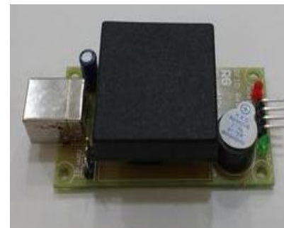
RFID EM18 125KHz USB output
